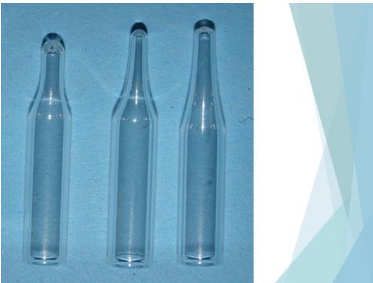
Abbildung 1: Aufsätze für HPLC-vials unterschiedlicher Länge und unterschiedlicher Verjüngung, Details, siehe Text
